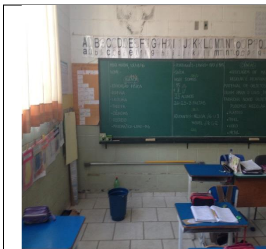
Balde utilizado dentro da sala de aula para conter a goteira
